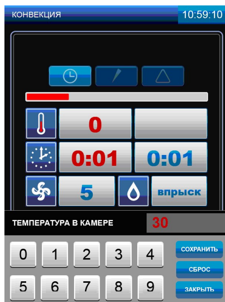
Рис. 12. Редактирование параметра « ТЕМПЕРАТУРА В КАМЕРЕ »
