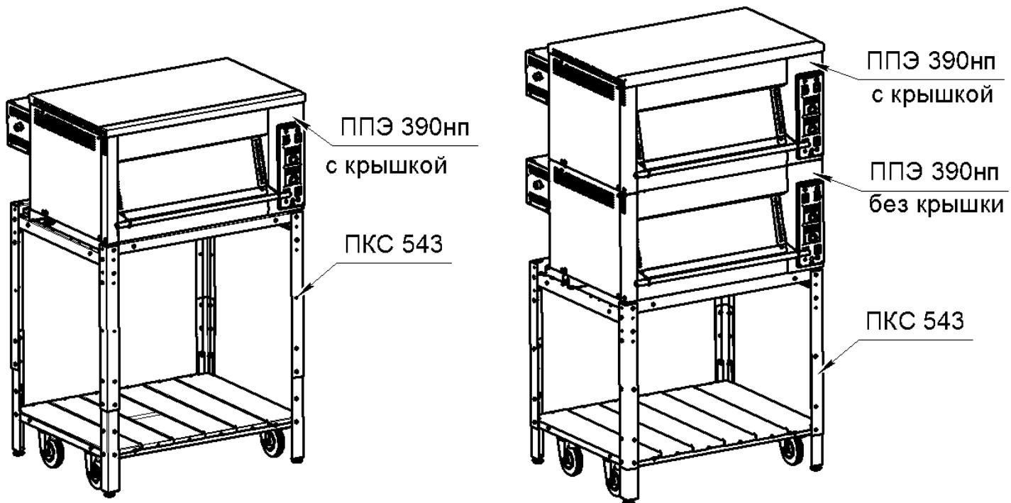
Порядок установки печей на подставку подробно указан в инструкции по сборке подставки ПКС 543
