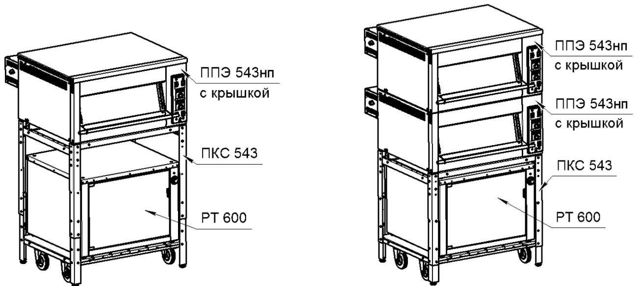
Порядок установки шкафа для расстойки теста РТ 600 в подставку ПКС 543 подробно указан в инструкции по сборке подставки ПКС 543
